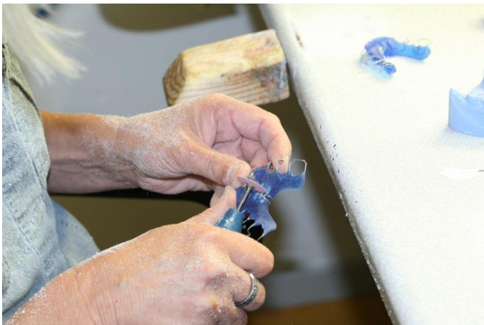
Trennen der Plattenhälften Das Sägen ist oftmals präziser als die Trennscheibe
